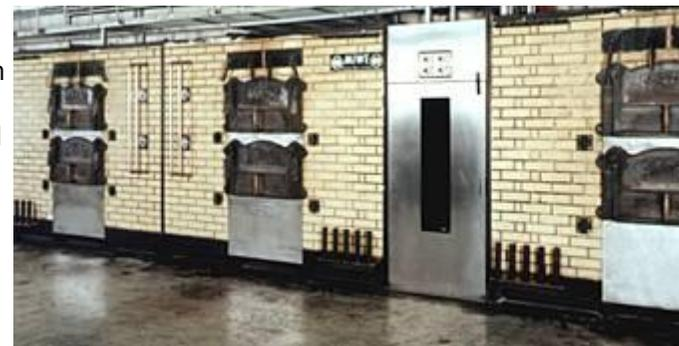
Altdeutsche Holzbacköfen MIWE AHO: Längst nicht mehr nur mit Holz beheizt, übernimmt der doppelherdige, gasfeuergestützte Holzbackofen die Produktion von Holzofen- und Bauernbroten - sogar in ganzen Batterien. Sie können sich entscheiden zwischen ein- oder zweierdigen Modellen -- siehe <http://www.miwe.com>
