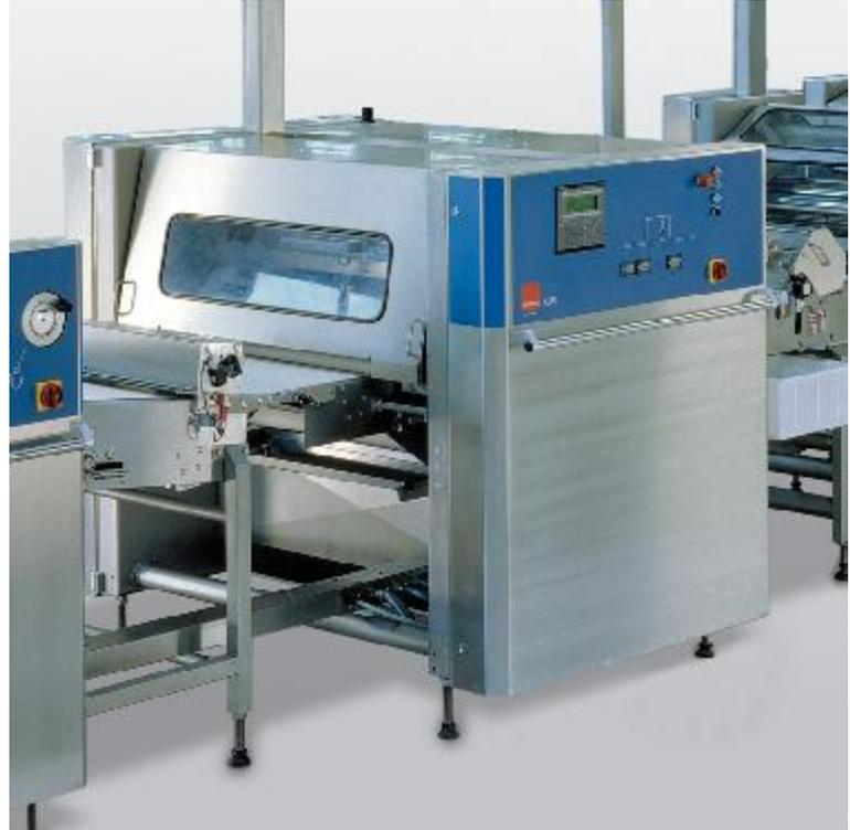
**Die CSTR ist eine Anlagenkomponente, die für die mehrzeilige Produktion gewickelter Erzeugnisse in hohen Stückzahlen ausgelegt ist. Sie brilliert bei Feingebäcken ebenso wie bei gefüllten oder ungefüllten Croissants, stellt aber auch artverwandt Rustikales her, etwa Salzstangen, Laugenstangen oder Kornstangen.**
