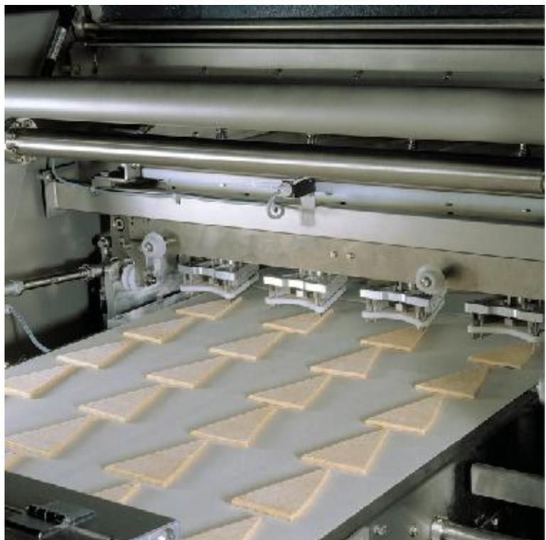
**Das CSTR-System stanzt aus einem kontinuierlich zugeführten, in Streifen geschnittenen Teigband präzise Stücke aus und setzt sie in Zeilen vollkommen frei auf einem Band zur weiteren Verarbeitung ab. Wobei es sie in einem Arbeitsschritt drehen und spreizen kann.**
