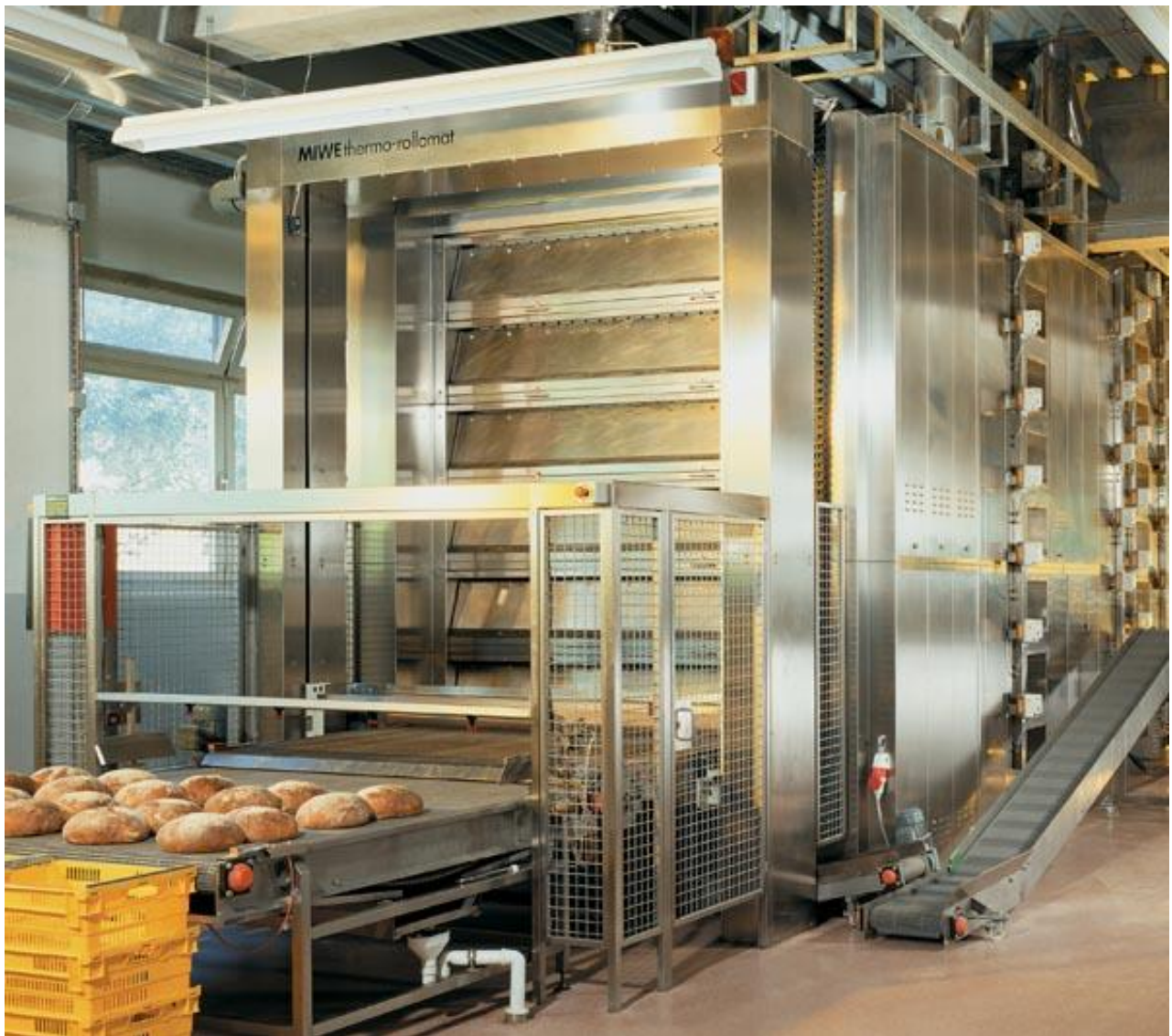
Der MIWE thermo-rollomat: Dieser Durchlaufofen ist mit seinem gleichmäßigen Backergebnis und seiner genauen Temperaturführung richtig groß in der Leistung, aber recht bescheiden im Anspruch.
