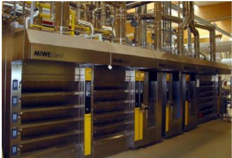
**Neben zwei 12-herdigen MIWE ideal Umluftöfen verfügt die Badische Backstub' über weitere zwei MIWE ideal Steinbacköfen, einen Umluft-Etagenbackofen nur für Laugengebäcke, einen für die Konditorei sowie drei MIWE thermostatic Wagenöfen. Insgesamt mehr als 160 Quadratmeter Backfläche, der gut 320 Quadratmeter Gär- und Kühlflächen -- MIWE Bäckerkälte -- gegenüberstehen.**
